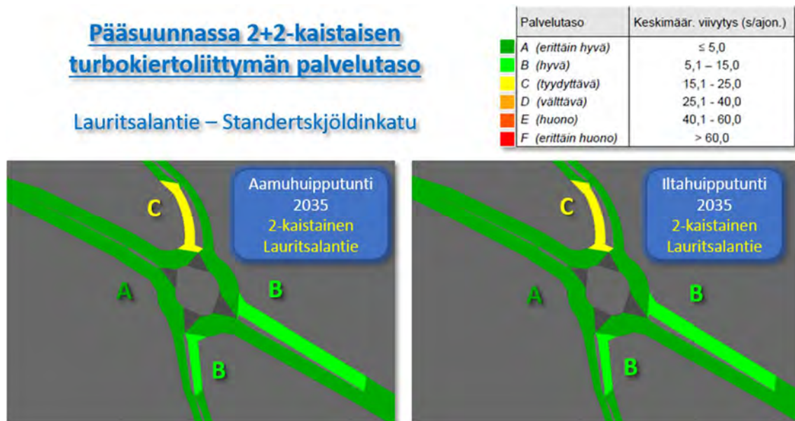
Kuva 9. Kaksikaistaisen turbokiertoliittymän palvelutaso aamu- ja iltahuipputuntien aikana vuoden 2035 liikennemäärillä.
